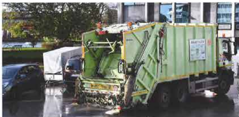
Er werd een wagen uit het wagenpark van Imog aangepast. Er kwam chassiswaag en een boordcomputer van Vanheede.
