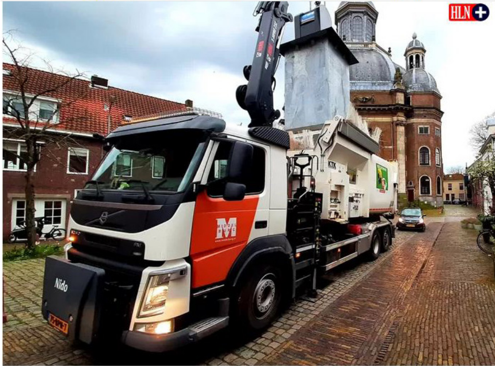
Ophalen van afval in Middelburg. Hier wordt een ondergrondse oudpapiercontainer gelegeerd in de binnenstad. © Theo Giele
